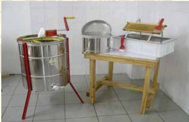
Picha 4: Vifaa vya kuchakatia mazao ya nyuki (Kushoto: mashine ya kuzidua asali; Katikati: chujio la asali; Kulia: chombo cha kuhifadhia asali inayochuruzika)
